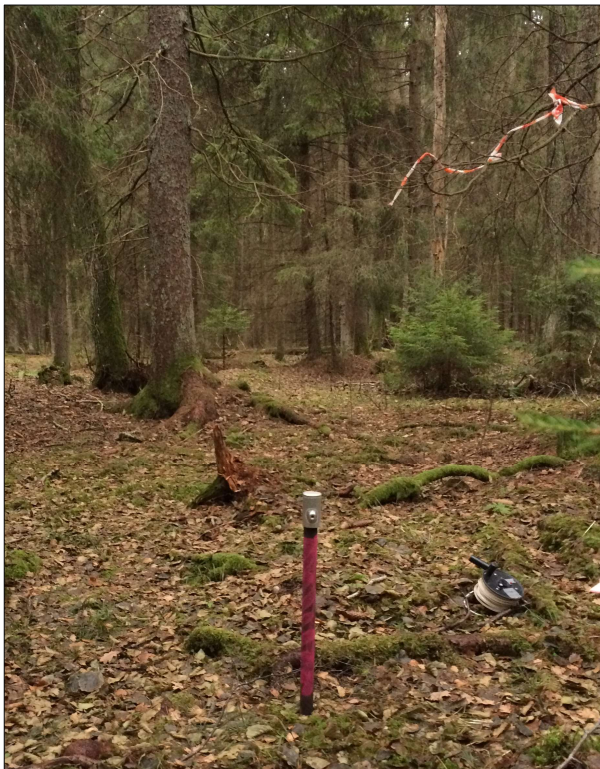
Figur 4. T.v. exempel på typiskt observationsrör. T.h. en nivålogger av typen TD-Diver™, ( www.vanessen.com ).
