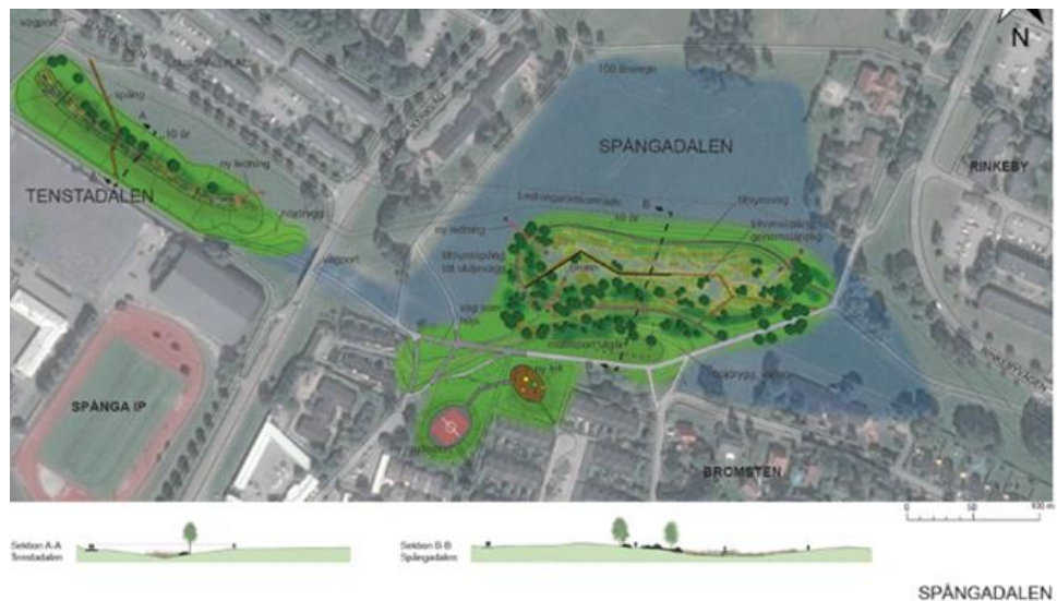
Figur 2. Illustration över dike och torrdammar i Spångadalen
