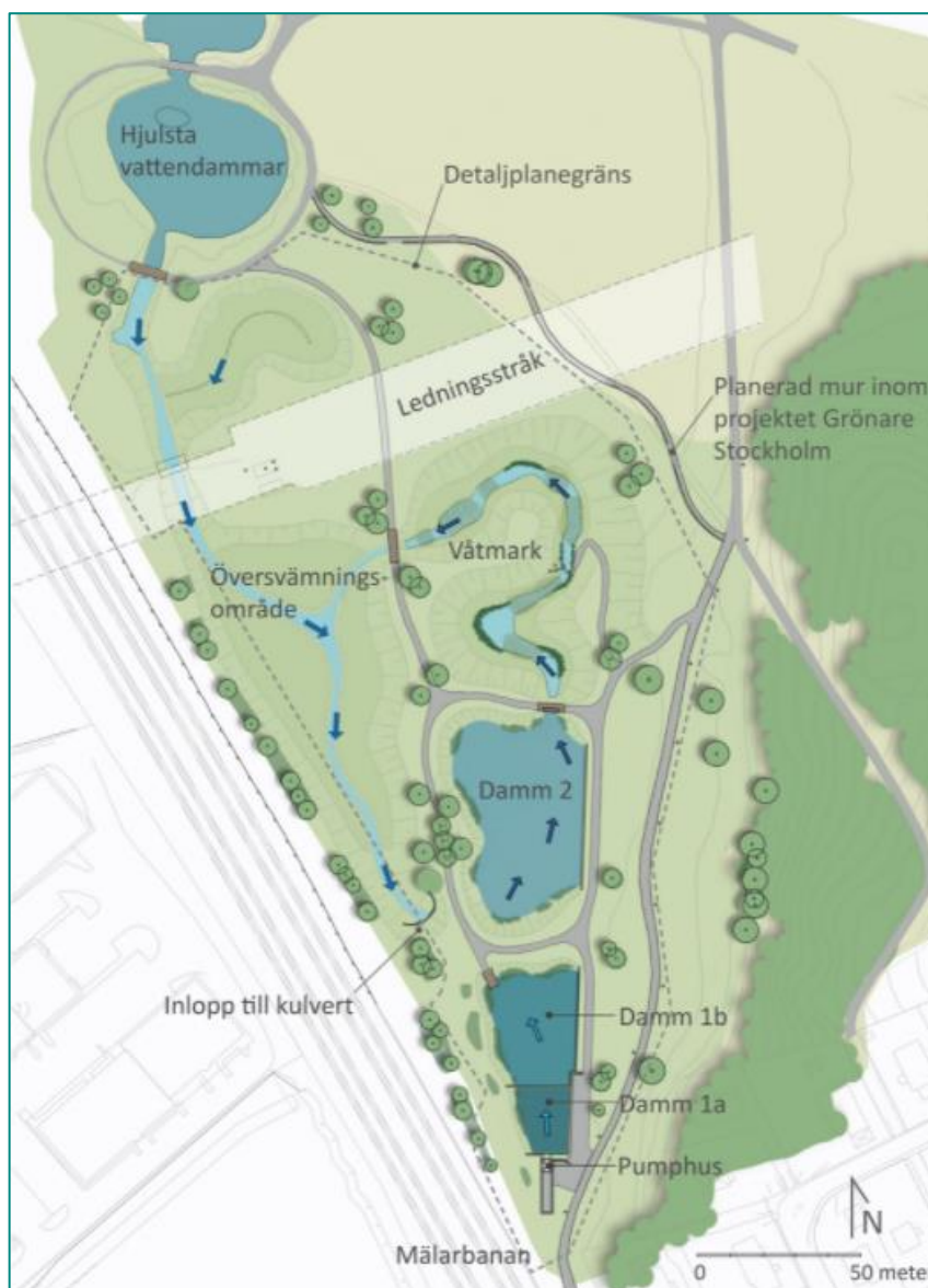
Figur 1. Illustrationsplan över Tenstadalens dagvattenpark. Pilar visar vattnets flödesriktning. Bild: Ramböll
