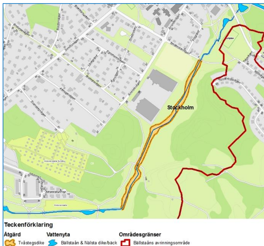
Figur 10. Föreslagen sträcka för tvåstegsdike i Nälsta dike/bäck
