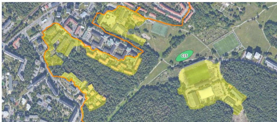
Figur 17. Åtgärd C15 (grön yta), avrinningsområde till torrdamm (gul yta) och gräns för tillrinningsområdet till Råcksta träsk (orange linje). Figur baserat på GIS-underlag från Sweco 2017, se referenser.
