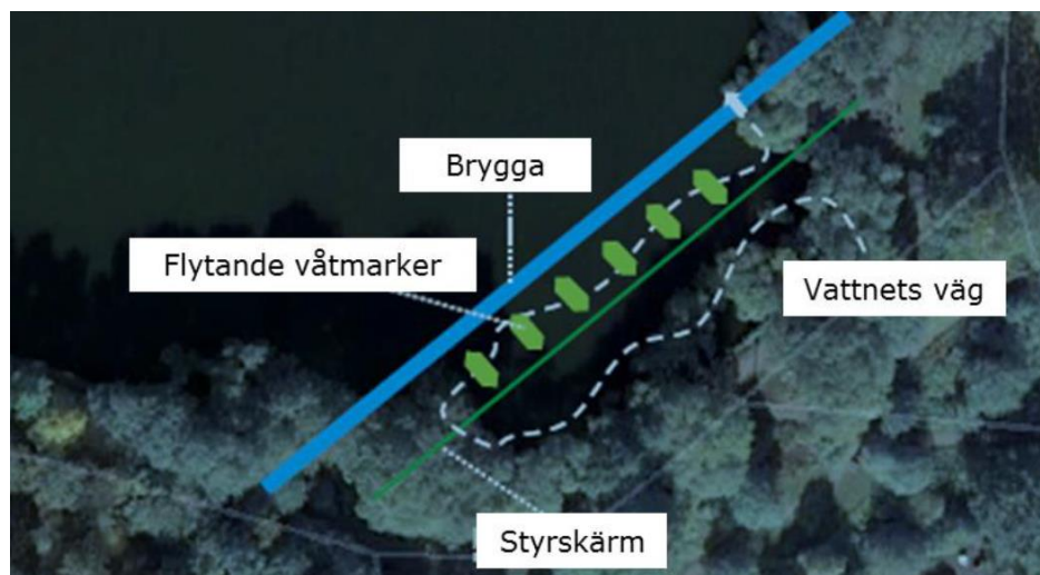
Figur 4. Förslag på skärmbassäng med flytande våtmarker. (WRS)
