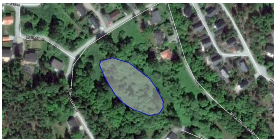
Figur 10. Illustration av ytbehov och ungefärlig placering av en dagvattendamm vid Blåklintsvägen på 0,4 hektar (våtyta), vilket motsvarar cirka 1 % av avrinningsområdets reducerade yta.
