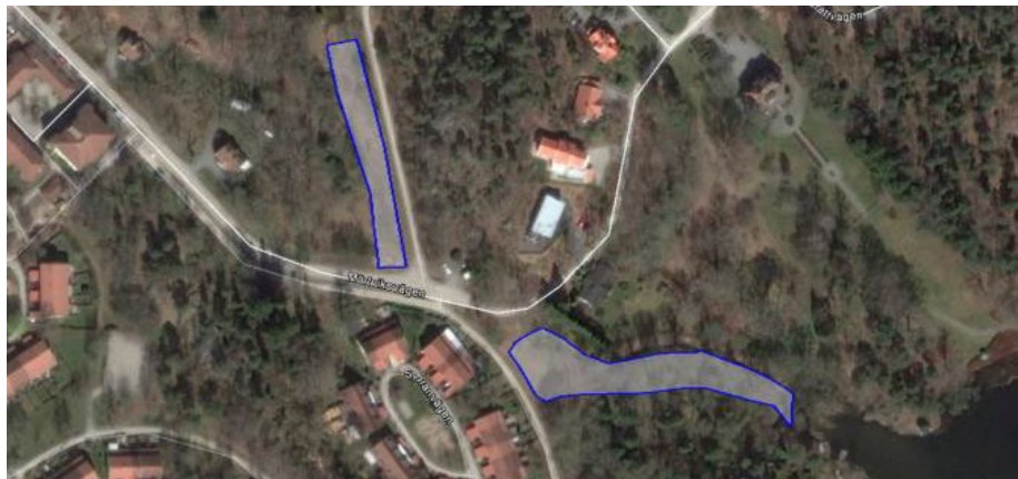
Figur 11. Ursprungligt förslag på möjlig placering av dagvattendammar. Efter vidare utredning har det visat sig att ytan närmast Mörtviken, som delvis består av en ravin, inte går att nyttja.
