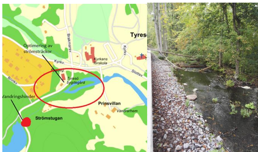
Figur 9 & 10. Röda markeringarna visar vart fiskevårdsåtgärder bör ske i Follbrinksströmmen. Röda punkten visar vart vandringshindret är placerat och den röda ringen visar vart optimeringsarbetet bör ske med tillsättning av större sten och block. Krontäckning saknas mot Brakmarsvägen. Problematiken kring dagvatten bör även ses över i och med den hårdgjorda ytan vid vägen och betongen.
