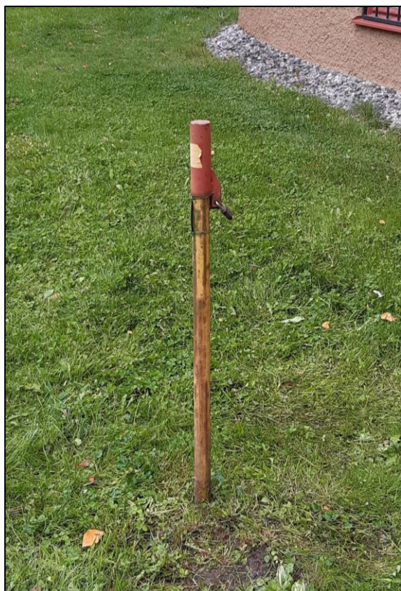
Foto 1. Nivårör nummer 10 (t.v.) och miljörör nummer 14, PEH-rör med galvaniserat skyddsrör på utsidan (t.h.).
