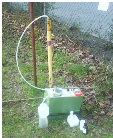
Figur 2. Provtagningsutrustning för provtagningen i nivå-rör, i nivå-rör under däcksel (till vänster), i den vanligaste typen av nivå-rör (till höger) och i miljörör (nedan).
