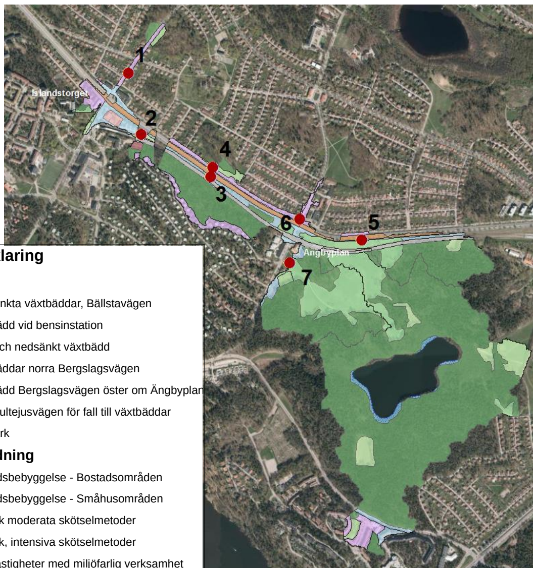
Figur 8 - Judarns avrinningsområde med sju åtgärdsförslag utmarkerade. För större figur se Bilaga 5.
