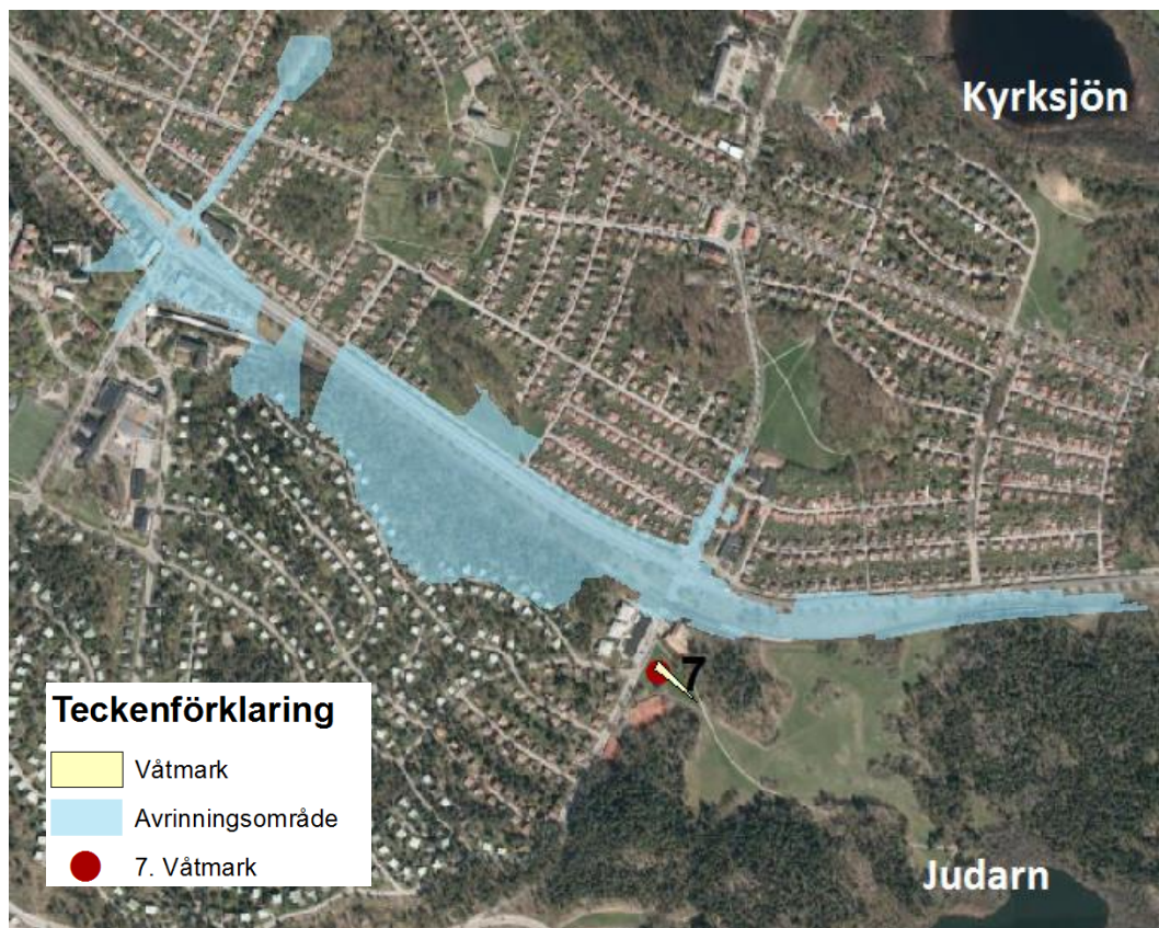
Figur 23 - Avrinningsområde till åtgärdsförslag i form av våtmark. Våtmark med en storlek på 660 m 2 illustreras i form av gul yta.
