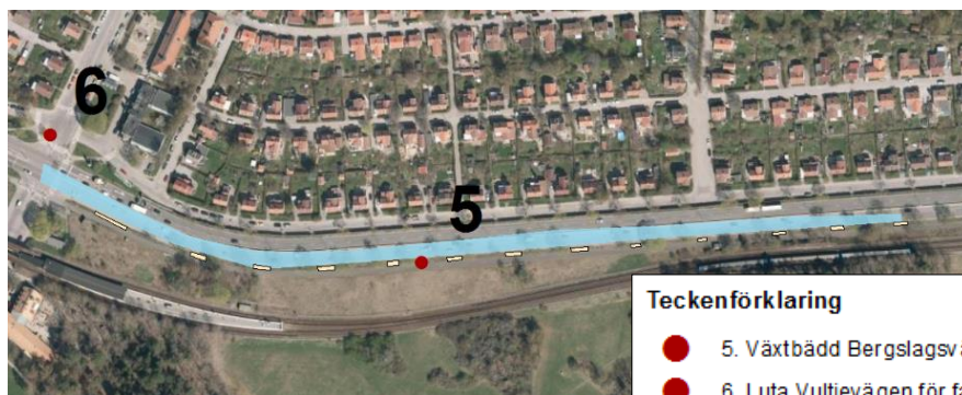
Figur 19 - Södra vägsträckan av Bergslagsvägen kan avledas till de växtbäddar som föreslås i åtgärdsförslag 5.
