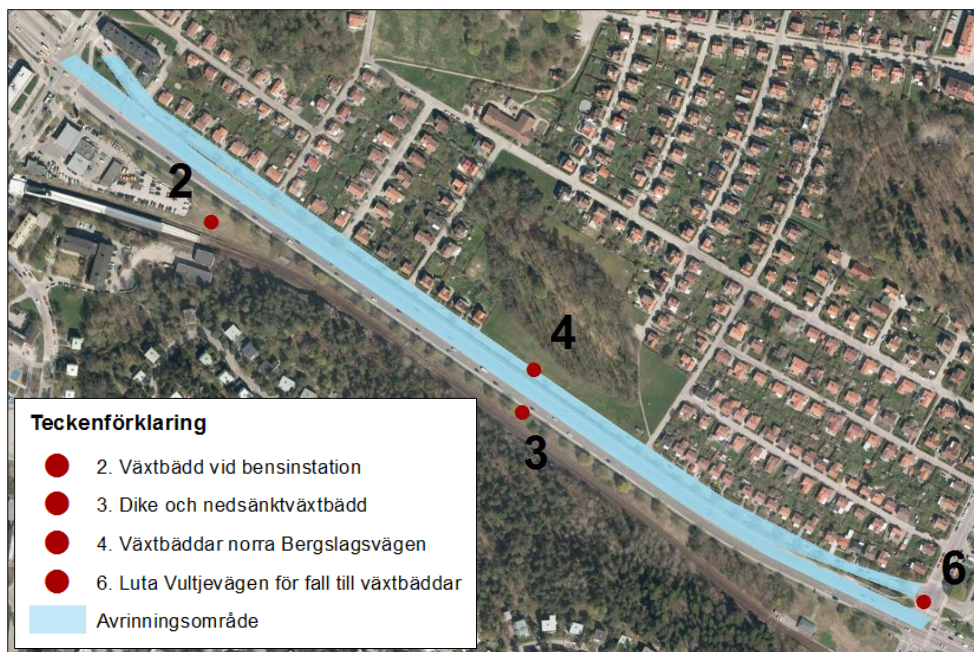
Figur 17 - Avrinningsområde till åtgärdsförslag 4 som utgörs av växtbäddar längs med norra sidan av Bergslagsvägen.
