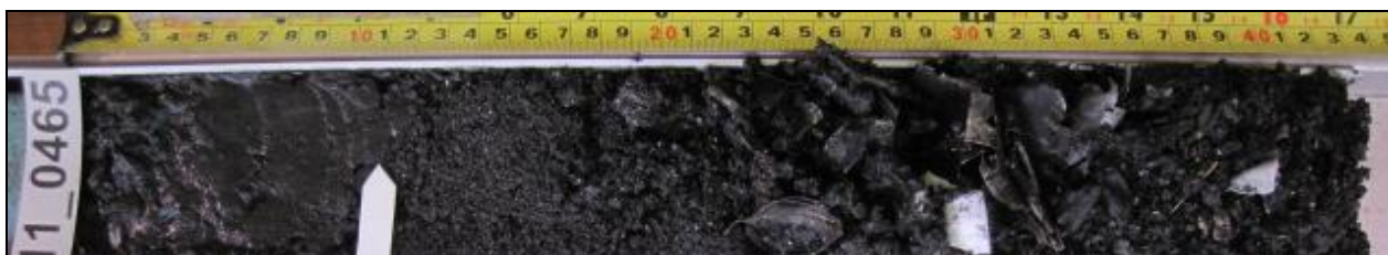
Sedimentkärna utvisande stratigrafien. Pilen markerar övergången mellan lergyttjan och mellansanden/slaggen som överlagrar soporna.
