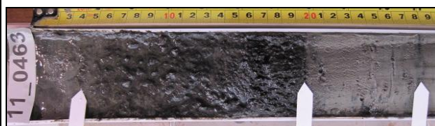
T.h. Pilarna visar gränsen mellan överlagrande grågrön lera och underlagrande svart lergyttja samt gränsen till den undre leran med sulfidfläckar.
