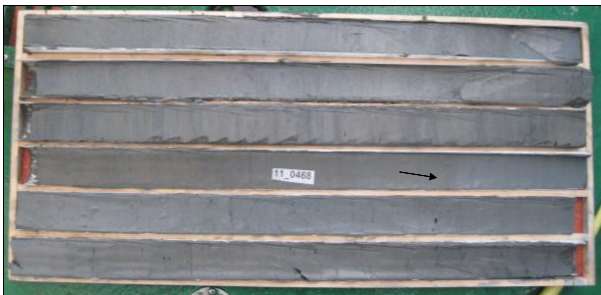
Borrkärna 11_0468. Upp = överst t.v., ned = nederst t.h.. Pilen pekar på övergången mellan postglacial och glacial (Ancyclus-) lera.
