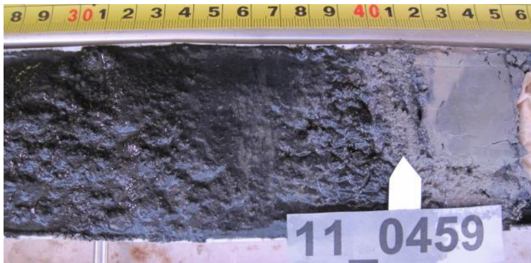
Detaljfoto av erosionskontakten (pilen) mellan lergyttjan och glacialleran.
