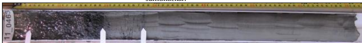
T.h. Pilarna visar gränsen mellan överlagrande grågrön lera och underlagrande svart lergyttja samt gränsen till den undre leran med sulfidfläckar.
