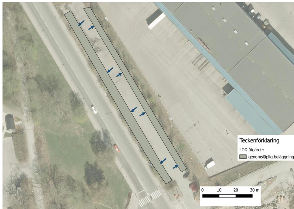
Figur 4. På en parkeringsplats utmed Västberga allé föreslås parkeringsytorna förses med genomsläpplig beläggning (grå fält).
