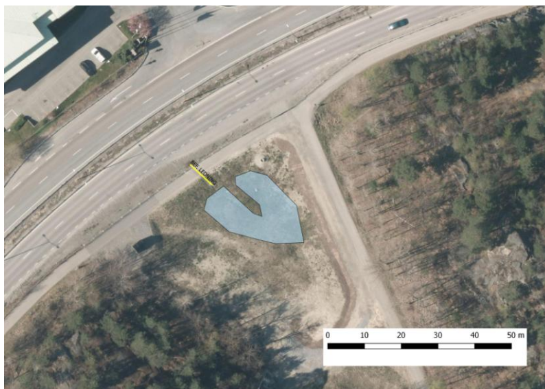
Figur 26. Möjlig placering av en ca 0,03 ha (våtyta) dagvattendamm vid Åbyvägen. Arean motsvarar cirka 1,5 % av avrinningsområdets reducerade yta. Foto Stockholm Stad. Den gula linjen representerar en relativt nyanlagd ledning som förmodas leda in dagvatten till den svackformade ytan.
